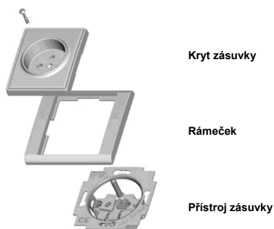
Obr. 5: Sestavování jednonásobné zásuvky s krytem a rámečkem
