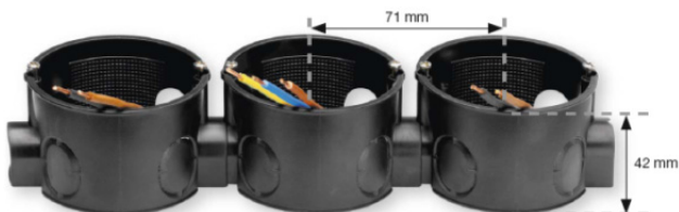
Obr. 1: Sesazení elektroinstalačních krabic pro vícenásobnou montáž
