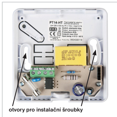
Obr.4 Nasad'te díl s elektronikou na spodní část a zajistěte pojistným šroubem.
