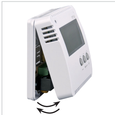
Obr.4 Nasad'te díl s elektronikou na spodní část a zajistěte pojistným šroubem.
